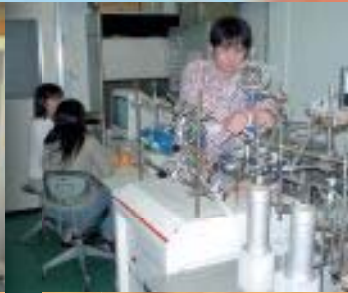
根建研究室の同位体比質量分析装置 炭素と硫黄の同位体比から生物の種類を推定する
